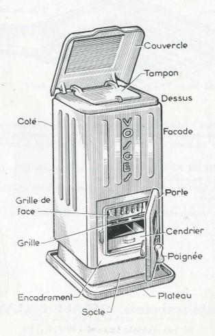
ENLEVEMENT DE LA GRILLE : le levier de manœuvre de grille étant ULTIMHEAT à fond vers l'arrière, ouvrir la grille de la façade, soulever du côté VIRTUAL MUSEUM grille vers le haut, retirer le rouleau avant en le poussant légèrement vers l'arrière et, ensuite, dégager par le bas. Tirer la grille vers soi.
